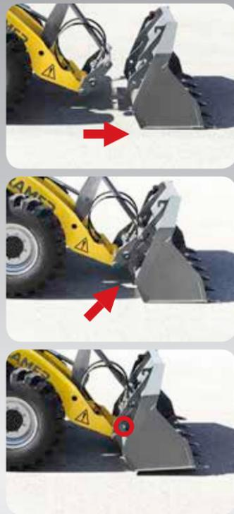
Optional kann der Öldruck am 3. Steuerkreis für einfaches An- und Abkoppeln von Anbaugeräten mit hydraulischen Zusatzfunktionen über einen Taster an der Ladeanlage druckentlastet werden.
