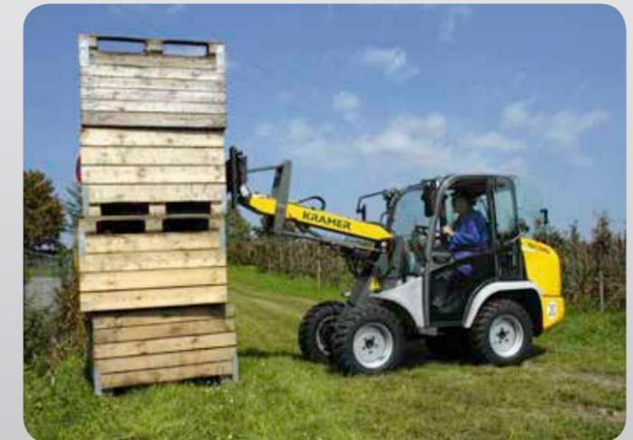
Die Parallelführung der Ladeanlage hält die Last sowohl im Schaufel- als auch im Stapelbetrieb immer perfekt in der Waage
