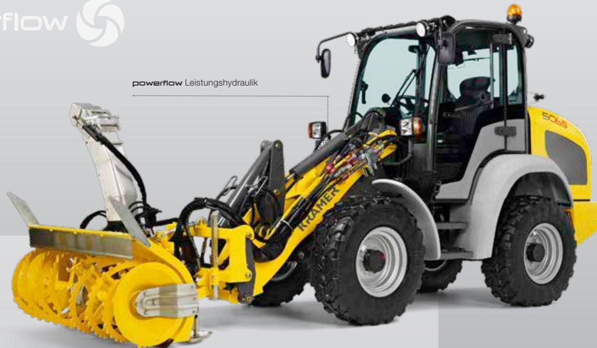
Die Arbeitshydraulik erlaubt feinfühliges Arbeiten bei geringen Bedienkräften und niedrigem Geräuschpegel in der Kabine. Zusätzlich sorgt der serienmäßige 3. Steuerkreis mit Dauerfunktion für effiziente und komfortable Bedienung von hydraulisch betriebenen Anbaugeräten. Passend dimensionierte Zylinder, effiziente Strömungsverhältnisse und angepasste Fördermengen ermöglichen schnelle Arbeitszyklen.
