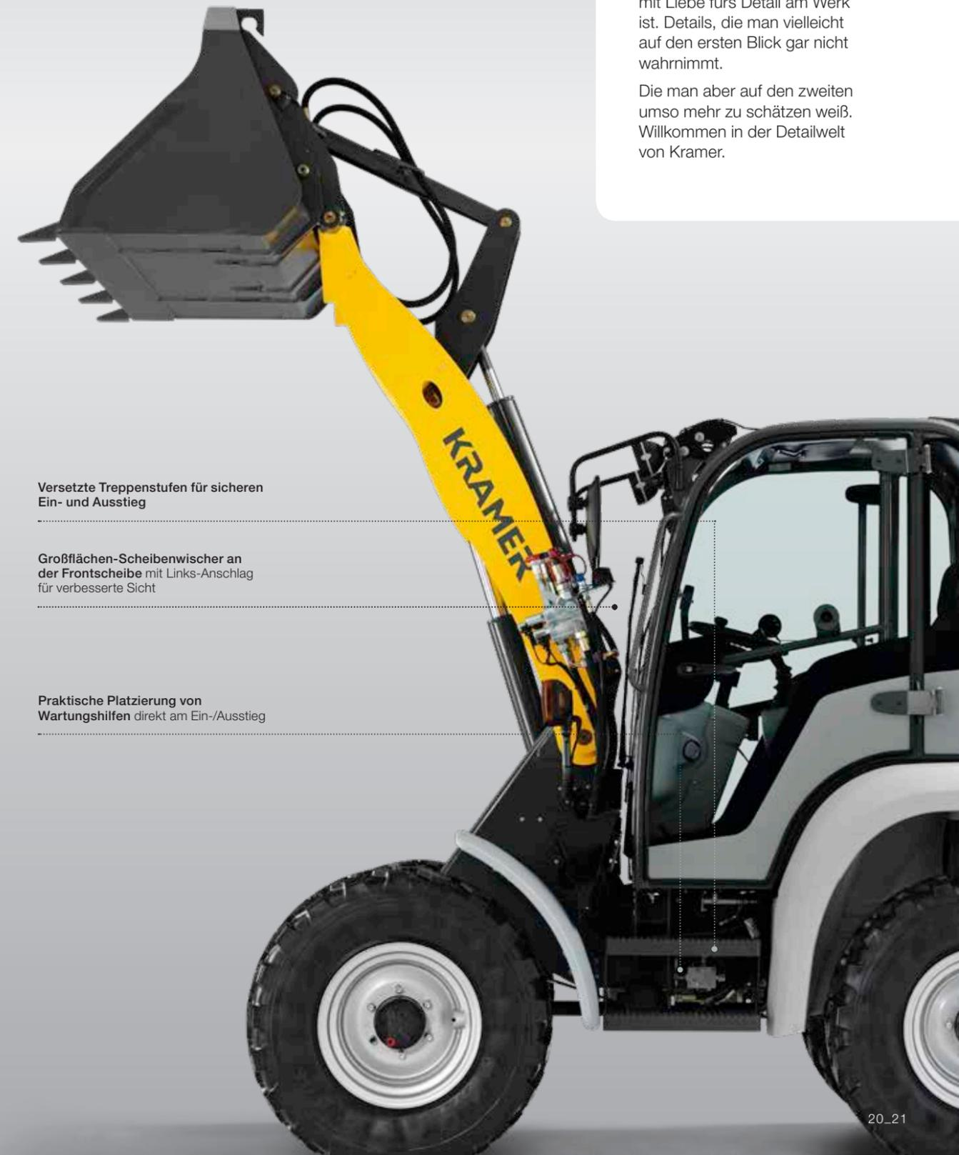
Versetzte Treppenstufen für sicheren Ein- und Ausstieg
