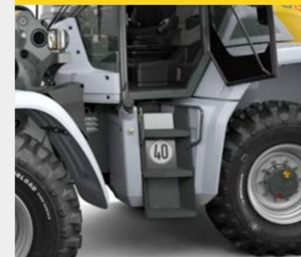
Die Fahrerkabine ist über die beidseitig, großzügig gestalteten Einstiegsbereiche über drei treppenförmige Stufen zu erreichen. Vier Haltegriffe (einer links an der A-Säule, zwei am Treppenaufstieg und einer an der Tür) ermöglichen einen sicheren Ein- und Ausstieg auf beiden Seiten. Auch eine Innenraumbeleuchtung mit Türkontaktschalter ist vorhanden.
