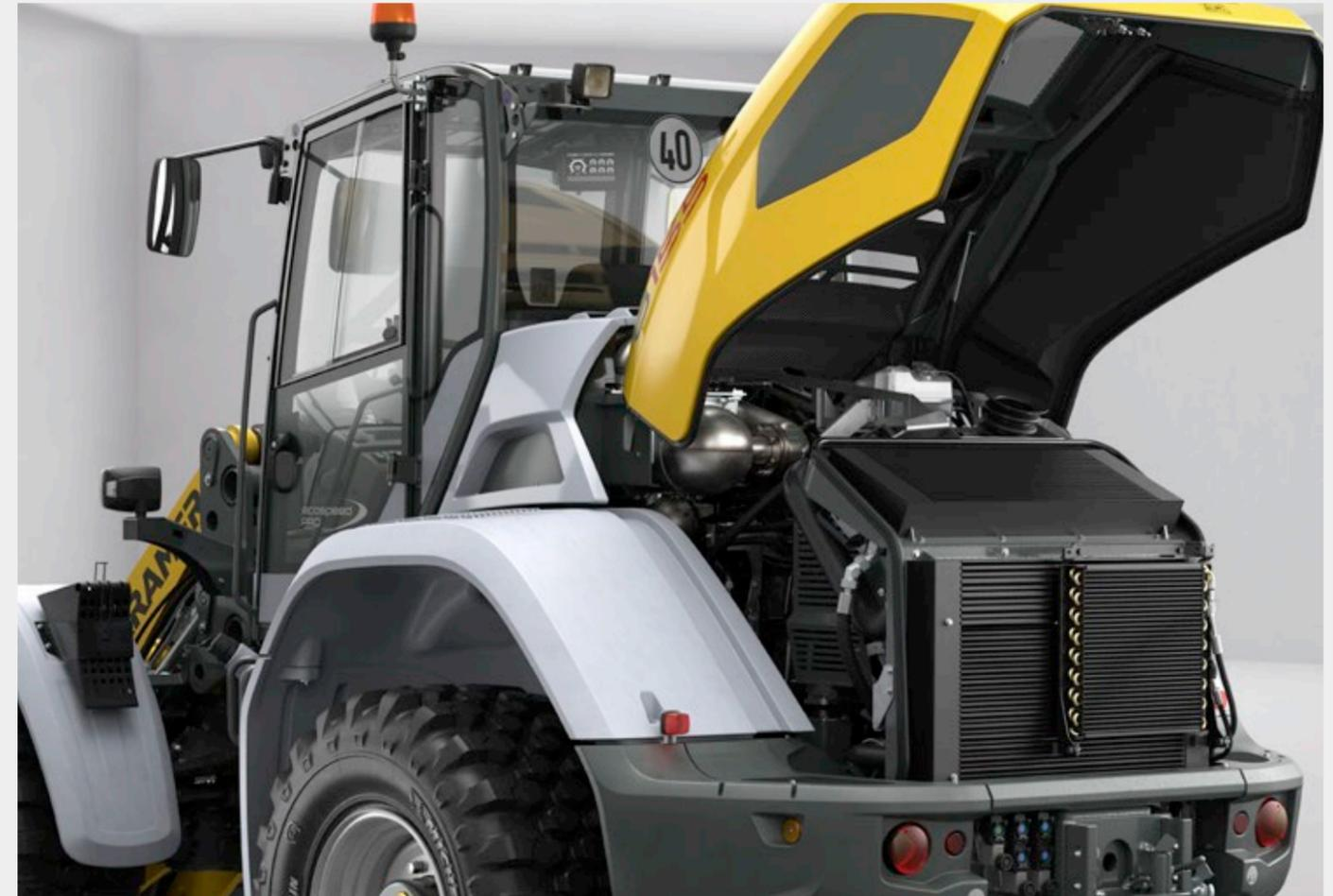
Wassergekühlter 4-Zylinder Reihenmotor mit gekühlter externer Abgasrückführung, Turboaufladung sowie Ladeluftkühlung.
