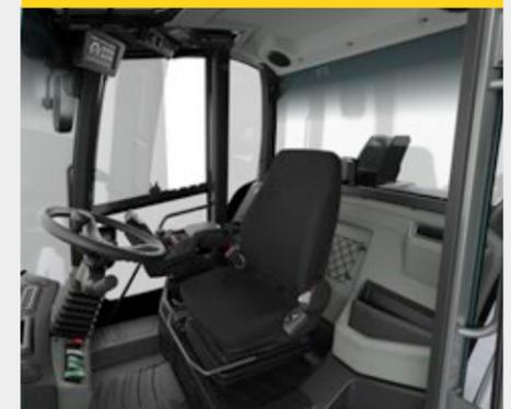
Durch das Kabinendesign wird der Fahrer vor Geräuschemissionen (70 dB(A)) geschützt. Außerdem können Klimaautomatik, Arbeitsscheinwerfer und Heckscheibenwischer seitlich oberhalb des 7-Zoll Displays gesteuert werden. Weitere Kabinenmerkmale sind: Bluetooth-Radio mit Freisprecheinrichtung, 12 V-Steckdose mit Schutzkappe, zwei USB-Anschlüsse uvm.
