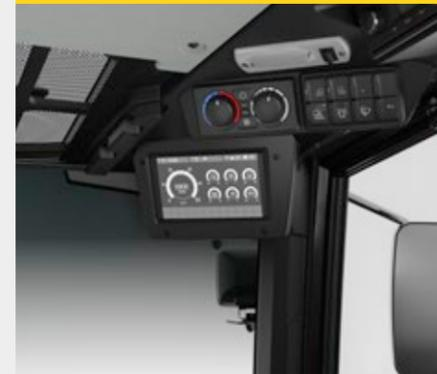
Der Radlader ist mit einem völlig neuen Bedienkonzept, mit großem 7-Zoll LCD Display, ausgestattet. Der Aufbau des 7-Zoll Displays ist einfach und intuitiv gehalten. Alle wichtigen Fahrzeugdaten und Funktionen werden im Hauptmenü angezeigt. Die Helligkeit lässt sich regulieren und individuell Ihren Bedürfnissen anpassen.
